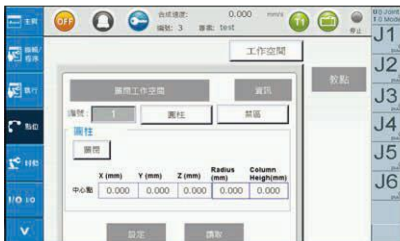
圖 2-33 點位資料 -Workspace 設定 (圓柱範圍教導方式)
