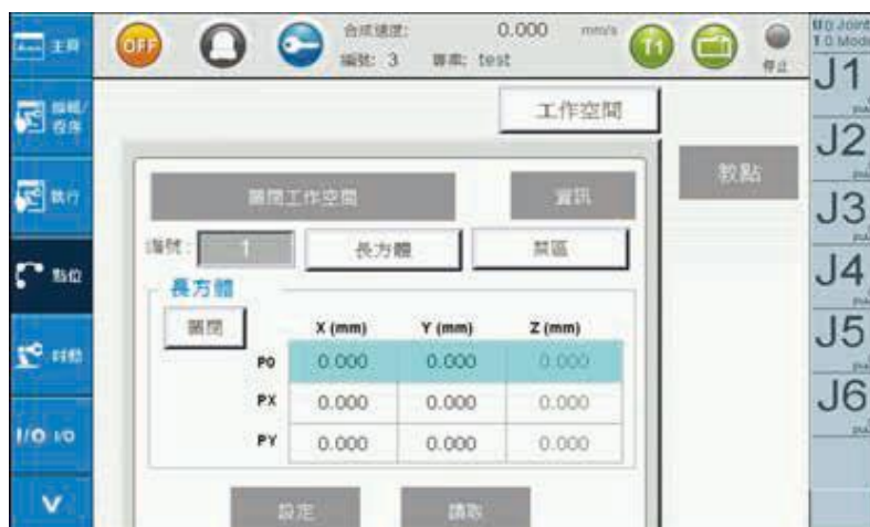
圖 2-34 點位資料 -Workspace 設定 (長方體範圍教導方式)
