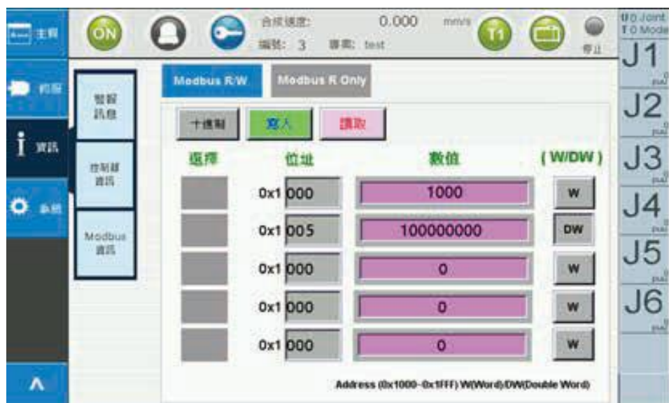
圖 2-43 Modbus 資訊 – 使用者可自行讀取 Modbus 位置資訊
