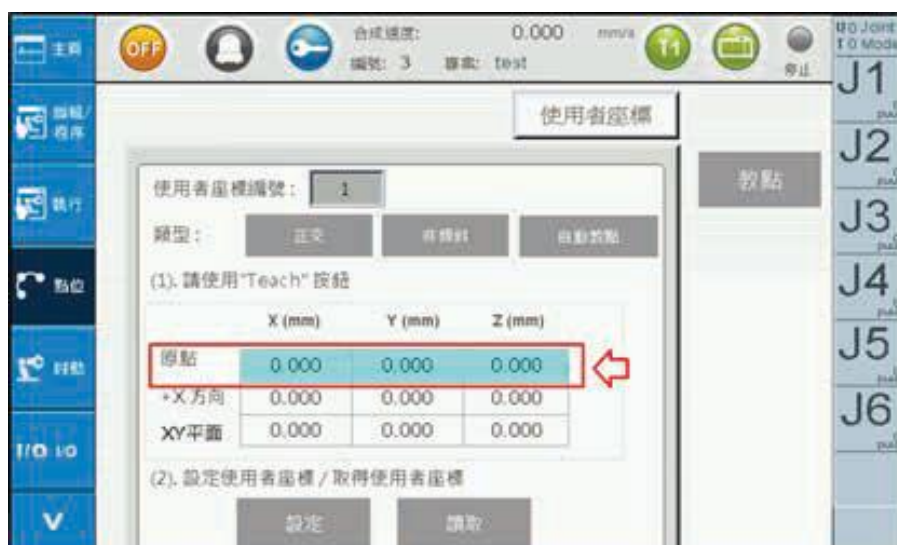
圖 2-21 點位資料 - 使用者座標原點設定
